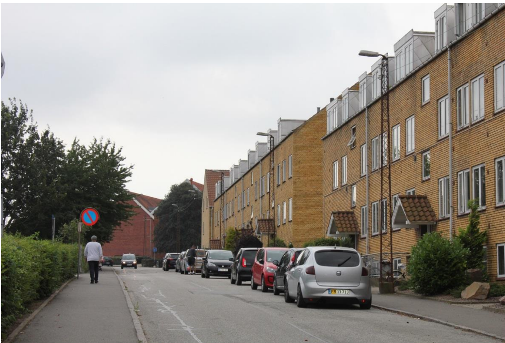
Figur 12. Fleretagers boligkvarter i Næstved med ældre belysning i form af kuffertarmaturer på gittermaster.
